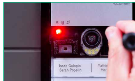
9. TRAMITE il selettore dedicato, entrare in modalità programmazione (l'ingresso in programmazione è segnalato dall'accensione del Led dedicato) e TRAMITE dip switch, selezionare il primo indirizzo da assegnare al primo pulsante
