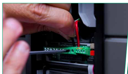
5. ALIMENTARE i moduli e COLLEGARE l'eventuale serratura
