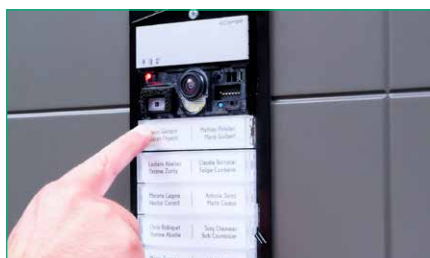
10. PREMERE il pulsante al quale verrà assegnato l'indirizzo selezionato al punto precedente. La corretta assegnazione dell'indirizzo è supportata da tono acustico di conferma. SELEZIONANDO in sequenza gli altri pulsanti, questi assumono automaticamente l'indirizzo di chiamata con codice successivo
