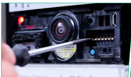
11. PORTARE i dip switch alla configurazione iniziale e USCIRE dalla modalità di programmazione (l'uscita dalla programmazione è segnalato dallo spegnimento del Led dedicato)
