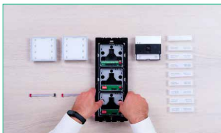
2. RIMUOVERE la cornice e posizionare i moduli tramite il sistema di aggancio rapido
