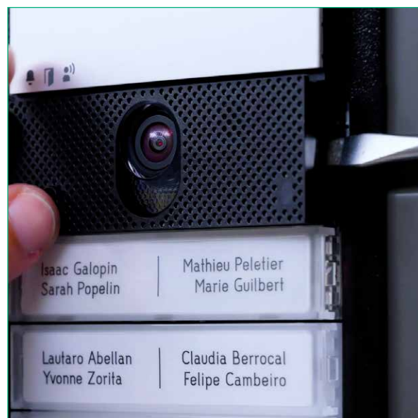
8. RIMUOVERE il frontale per accedere alle varie programmazioni/regolazioni
