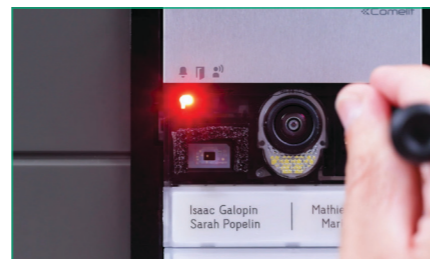
9. MEDIANTE el correspondiente selector dedicado, entrar en el modo de programación (la entrada se confirma con el encendido del correspondiente led) y MEDIANTE el DIP-switch, seleccionar la primera dirección que se asignará al primer pulsador
